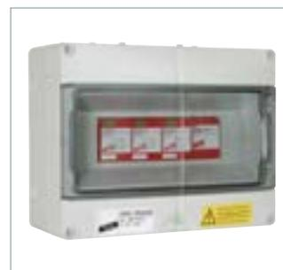
Además de la indicación visual estándar con ventanilla de inspección de color verde-rojo, la variante del equipo DEHNgard 1000 (FM) dispone de una borna de conexión tripolar para señalización a distancia. Es un contacto conmutado libre de potencial que puede utilizarse como contacto normalmente abierto o como contacto normalmente cerrado.
