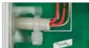
Fijación del conductor mediante bridas de cable.
