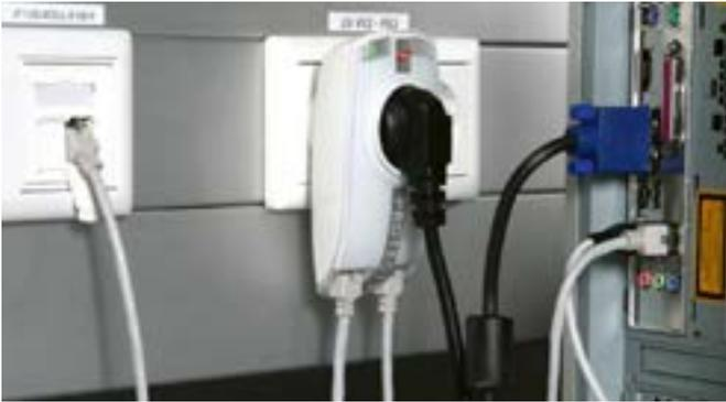
Adaptador combinado de protección contra sobretensiones para conectar en las cajas de enchufe, con indicación óptica de servicio y de averías.
