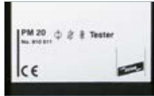
Se puede comprobar el comportamiento de respuesta de los descargadores de gas, de los varistores y de los diodos Zener.
