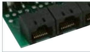
Con conexionado RJ45 para montaje a posteriori.
