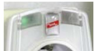
Indicación óptica del estado de funcionamiento / fallo del lado de energía (230 V).
