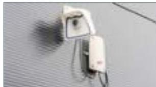
Idóneo para su instalación en el exterior con protección IP66.
