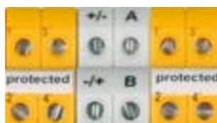
Interface de comunicación RS485 A/B (sólo DRC MCM XT) para soluciones de comunicación y puentes.
